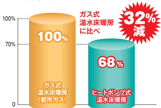
(試算条件) ガス熱源は1kWhあたりのランニングコストで比較
