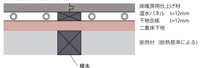
断熱材、下地合板、置床及び床暖房用仕上げ材の施工に関しましては、各メーカー様の施工説明書に従い、必ず専用又は指定の接着剤、釘をご使用ください。
