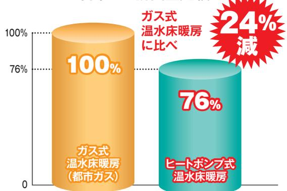
(試算条件) ガス熱源は1kWhあたりのCO<sub>2</sub>排出量で比較
